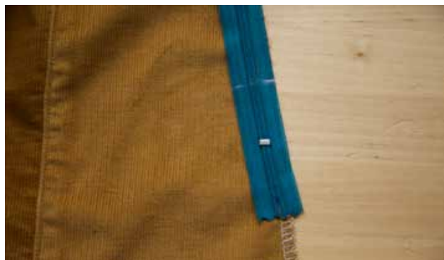
Marquez la fin de la première piqûre sur l'autre partie de la fermeture à glissière.
