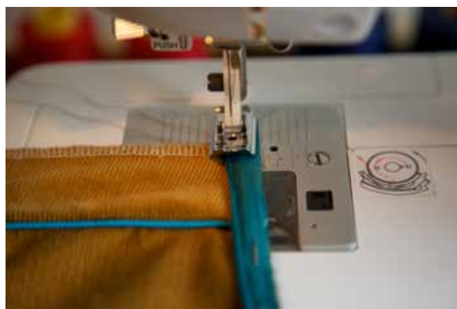
Placer une fermeture éclair invisible avec un pied-de-biche spécial
